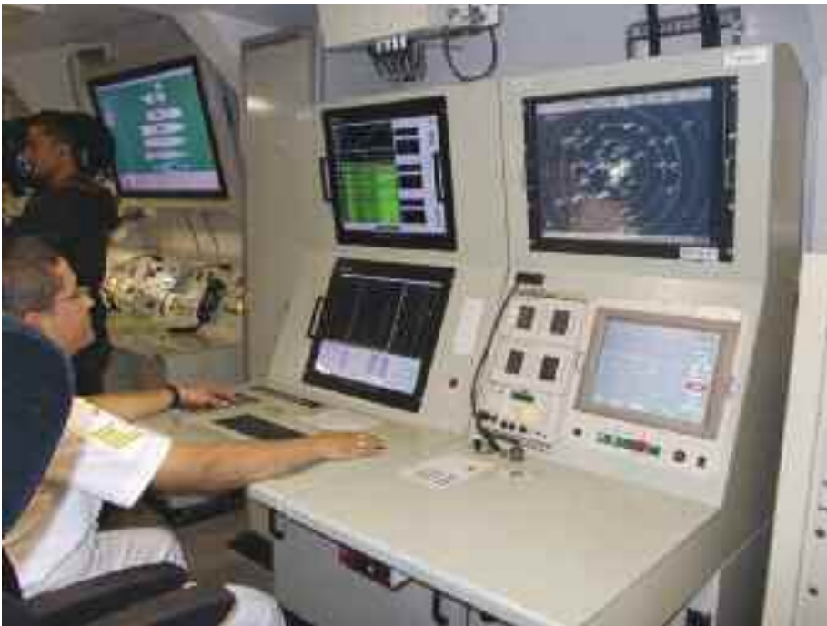
TCG Heybeliada korvetinin SHM'nde yer alan karinaya monteli Yakamoz aktif/pasif sonar sistemine ait operatör konsolu [sol ünite] görülüyor [Fotoğraf: İ. SÜNNETÇİ/S&H].
