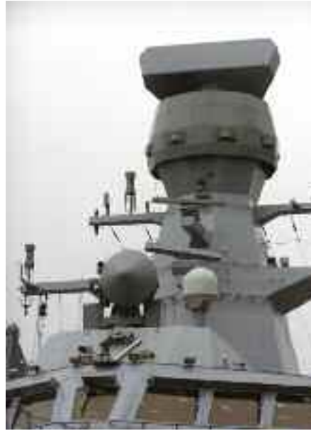
TCG Heybeliada'nın 3-Boyutlu Arama Radarı Smart-S Mk2, MilGem Projesi ile birlikte Türk Deniz Kuvvetleri hizmetine girmiştir. Hollanda da yerleşik Thales Nederland ürünü Smart-S radarı için Türkiye'de Aselsan ile bir işbirliği oluşturulmuştur [Fotoğraf: S&H Arşivi].
